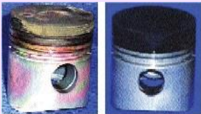
Abbildung 1: Der mit SilcoKlean®1000 beschichtete Kolben (links) zeigt eine weitaus geringere Ablagerung von Kohlenstoff als der unbeschichtete Dieselpilben (rechts).
